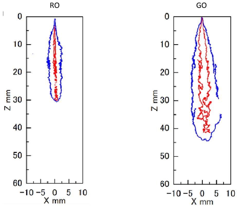
(a)  $P_{inj}=40\text{MPa}$ ,  $T_i=298\text{K}$ ,  $t=0.5\text{ms}$
