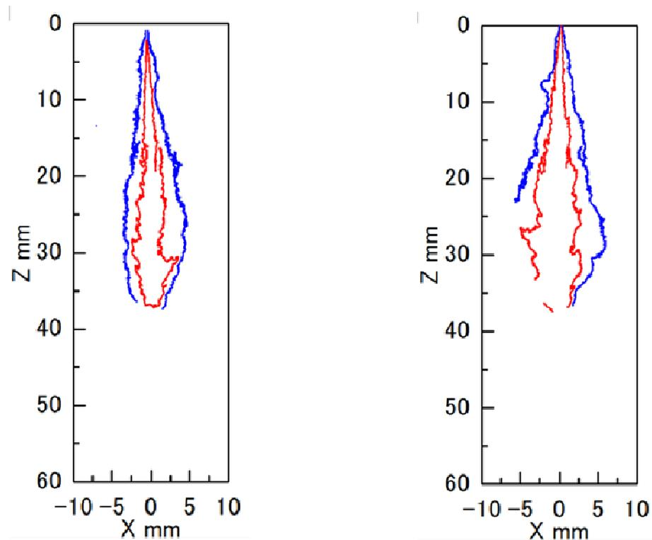
(b)  $P_{inj}=40\text{MPa}$ ,  $T_i=700\text{K}$ ,  $t=0.5\text{ms}$
