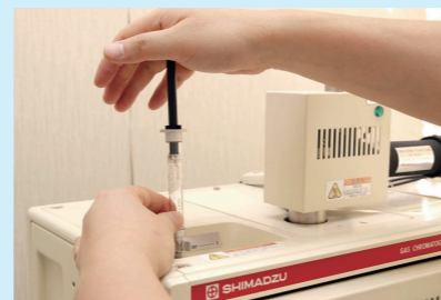
▲ガスクロマトグラフィーに、採取した口内気体を注入しているシーン。
