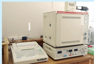
▲「ガスクロマトグラフィー」口臭の原因である揮発性硫黄化合物の分析を正確に行ってくれる。
