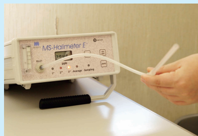
▲「ハリメーター」。ストローをくわえて直接口臭を測定する機器。
