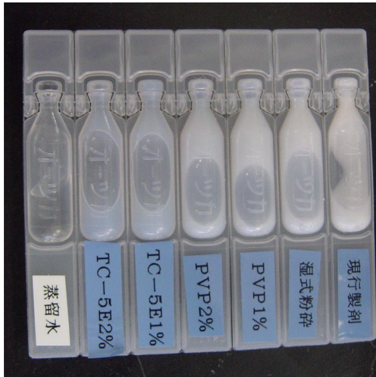
図2-1 1 2%レバミピドナノ粒子懸濁液 (2%TC-5, 1%TC-5, 2%PVPK25, 1% PVPK25) 及び湿式ビーズミル粉碎懸濁液とレバミピドマイクロ粒子懸濁液 (市販同等品) の外観
