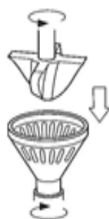
図2-7 超高速液-液せん断（クレアミックスダブルモーション）の分散化機構（文献60から引用）
