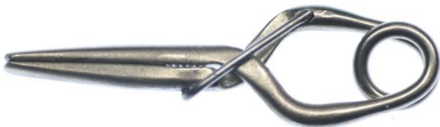
図 3 Au-7Nb-5Pt 合金製試作脳動脈瘤クリップ
