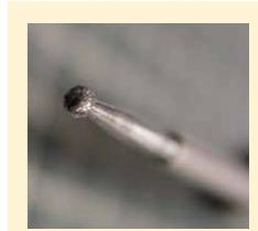
内視鏡下手術のドリルには、骨を削るためのダイヤモンド粒子が使用されている。
