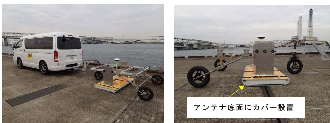
図 3.18 車両によるレーダ装置の牽引
