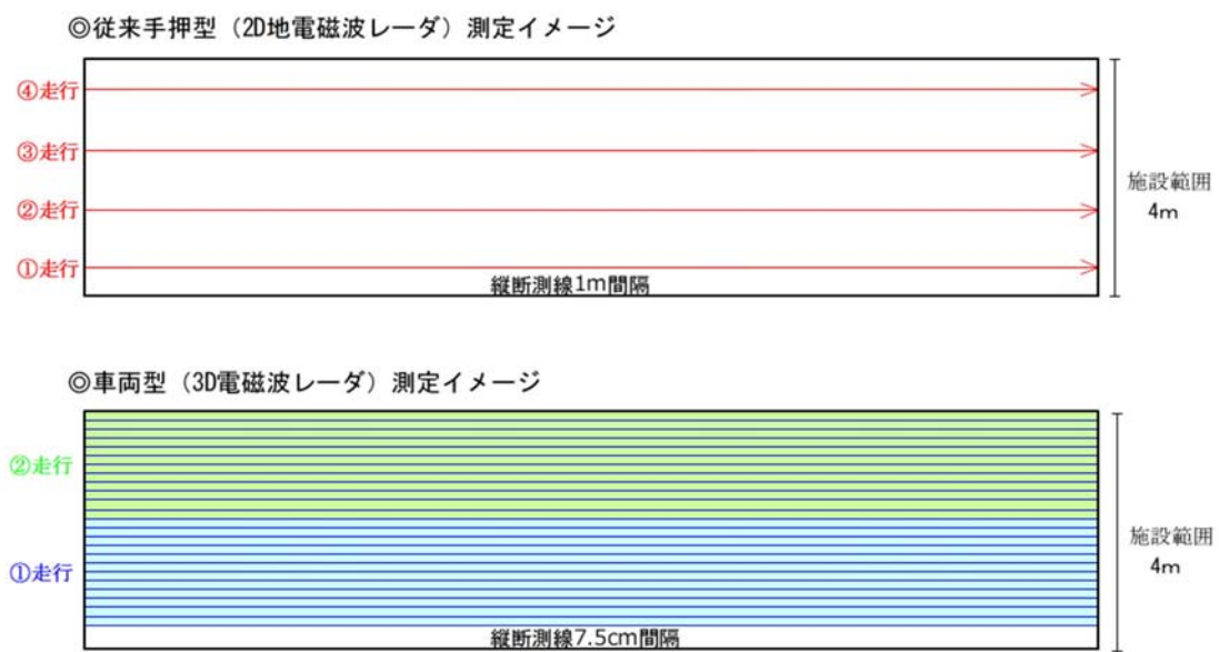
図 3.7 3D電磁波レーダの測線設定イメージ
