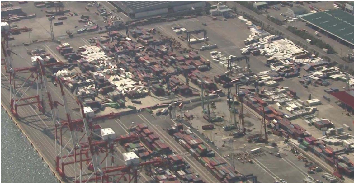
図 1.8 平成 30 年台風 21 号におけるコンテナ散乱状況（大阪港） 7)
