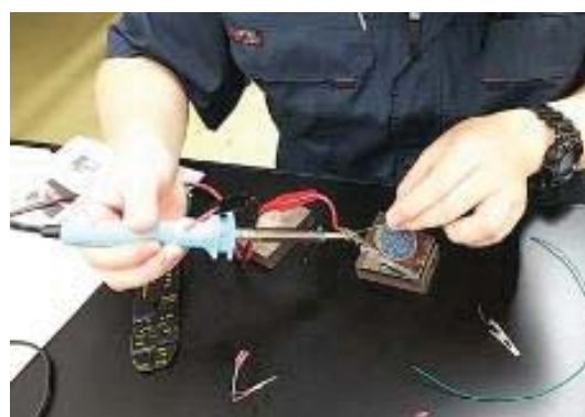
図3 みの虫クリップの取り付け
