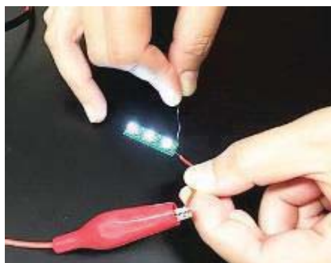
図6 チップLEDの点灯確認
