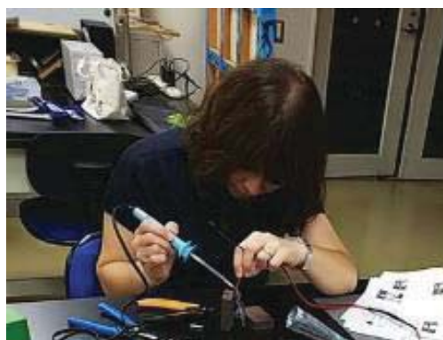
図4 バナナプラグの取り付け
