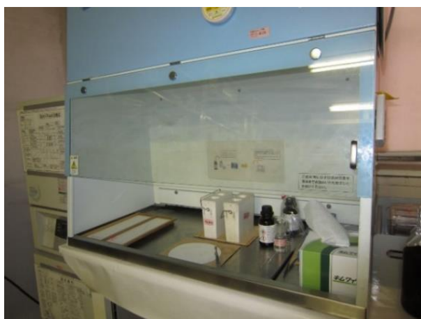
図2 有機溶剤用局所排気装置 日本医科 FH-850
