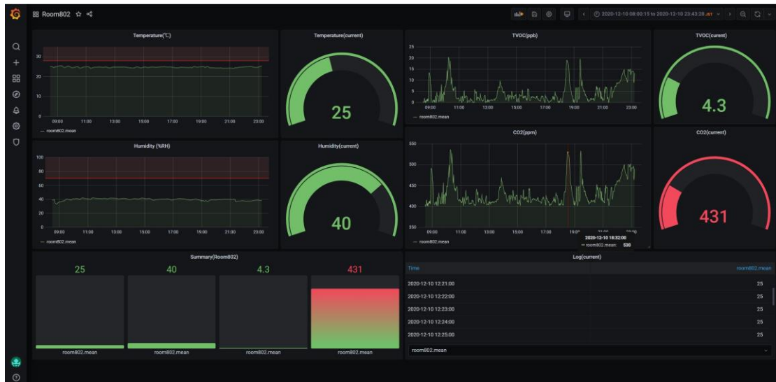
図5 クラウドサーバ上のデータ可視化基盤(Grafana)による計測結果のブラウザ表示 (温度, 湿度, CO2 濃度, TVOC)
