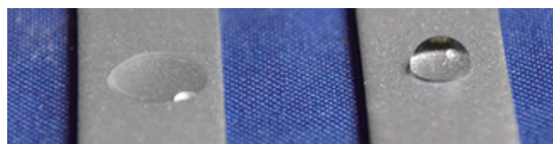
図1 皮膜形成アミンによる防食皮膜処理を施したテストクーポンの撥水性。左が無処理、右が皮膜処理したもの。
