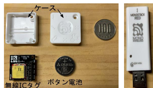
写真-2 無線 IC タグの外観(左)とパソコンに取り付ける送受信機(右)
