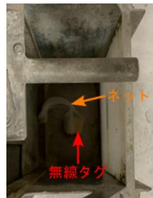
写真-4 無線 IC タグの設置方法
