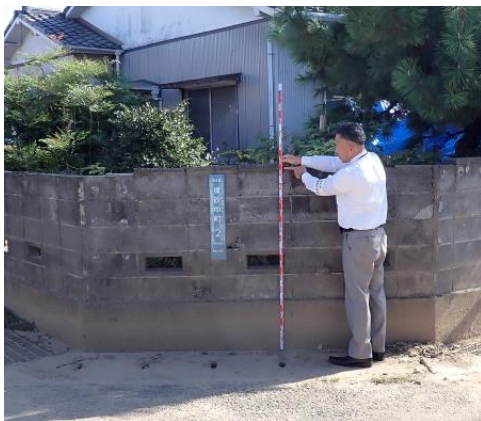
写真-1 浸水痕跡調査の状況(庵原川左岸地区)
