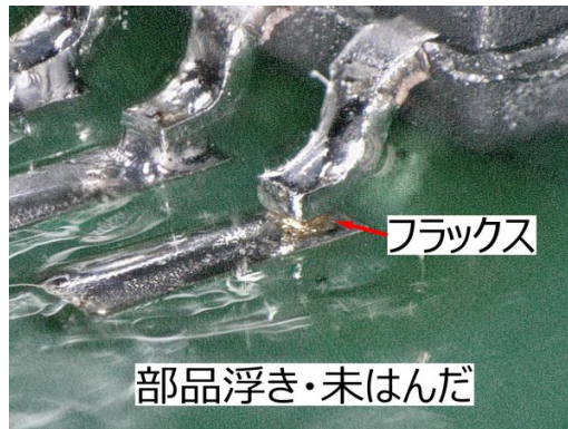
図 2.7 SOP IC と PCB 間にはんだ付け時に発生した断線例 [2]
