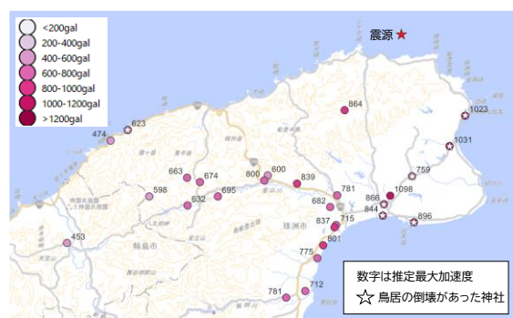
図-10 鳥居が倒壊した神社
