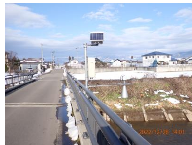
図-4 危機管理型水位計(前田橋)
