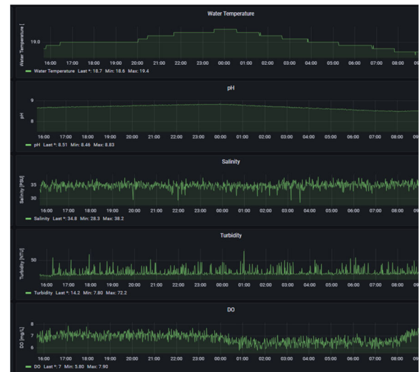
図8 Grafanaによるセンサの時系列データの可視化（水温、pH、塩分濃度、濁度、溶存酸素）
