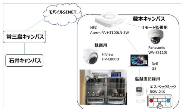
図1 モバイルSINETのみの構成
