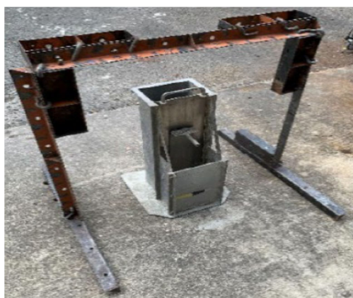
図 4.6 加振ボックス充填装置および鋼製フレーム
