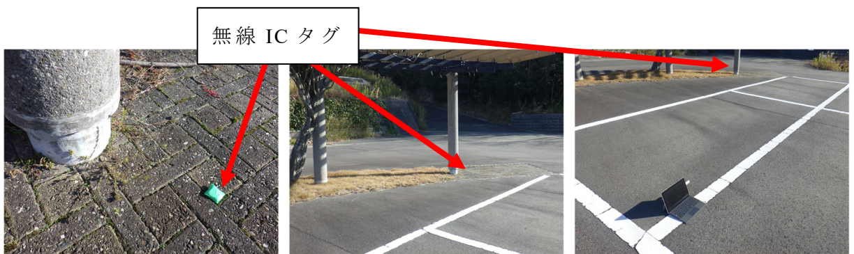
図 7.10 屋外での無線 IC タグの通信適用確認
