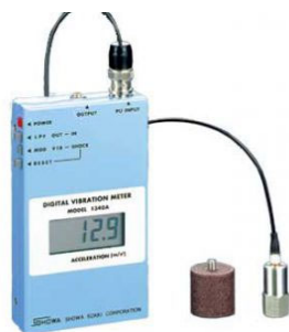
図 4.1 有線加速度計（外部接触型） 2) 図 4.2 有線加速度計（埋設型） 3)
