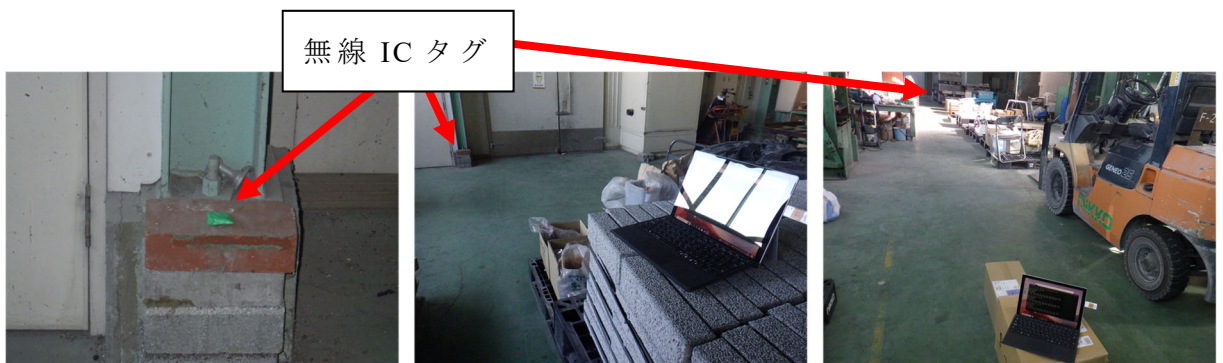
図 7.11 屋内での無線 IC タグの通信適用確認
