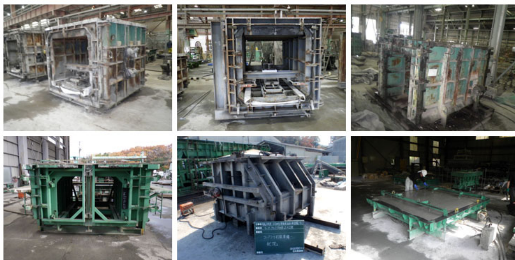
図 2.2 主なプレキャストコンクリート型枠 (上段：ボックスカルバート×2，水路製品) (下段：L型擁壁，魚礁ブロック，スラブ)
