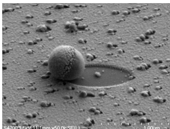
図 3-3 斜め蒸着後の Semi-shell 構造
