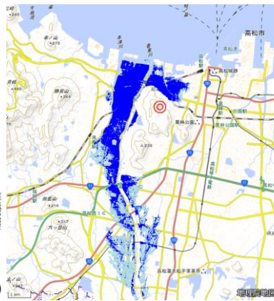
図-6 破堤から5時間後の浸水状況
