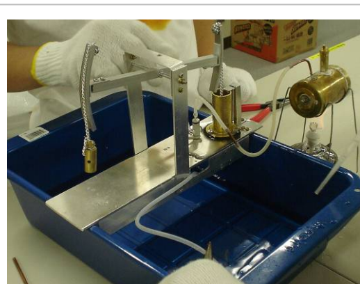
図3 試運転中のアルミ製のエンジン
